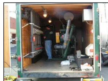
Figura 1. Prueba de SVE. En Octubre, la EPA llevó a cabo una prueba de SVE cerca de presuntas fuentes de contaminación. (Fuente: EPA)
