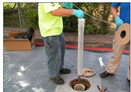
Figura 2. Ejemplos de muestreo de agua de norias usando la técnica de muestreo Hydrasleeve™. (Fuente: EPA)
